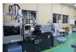
住友重機:SE30t 【除湿乾燥機取付】
